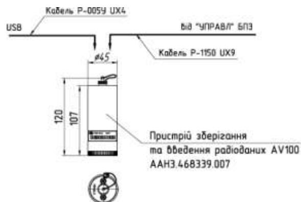
Рисунок 6 – Схема з'єднання пристрою зберігання та введення радіоданих
