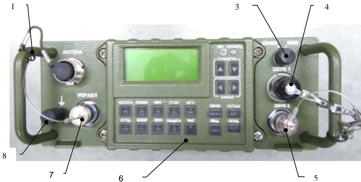
Рисунок 5 – Прийомопередавач , передня панель
